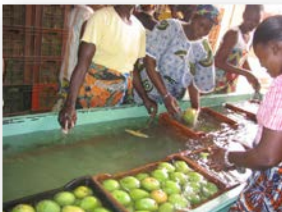
Bac de lavage des mangues par immersion (Photo B. Samb)
