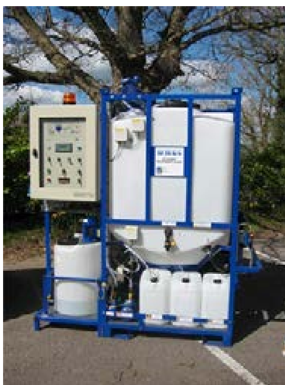
Pour traiter les effluents phytosanitaires issus de traitements post-récolte, le dispositif SENTINEL conçu par WMEC (R-U).
