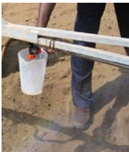
Test de débit des buses et de la rampe avec de l'eau claire, après rinçage soigné de l'appareil. (Photo B. Schiffers)
