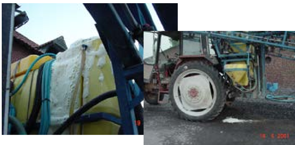
Débordement de la cuve et fuites pendant le remplissage (Photos Phytophar).
