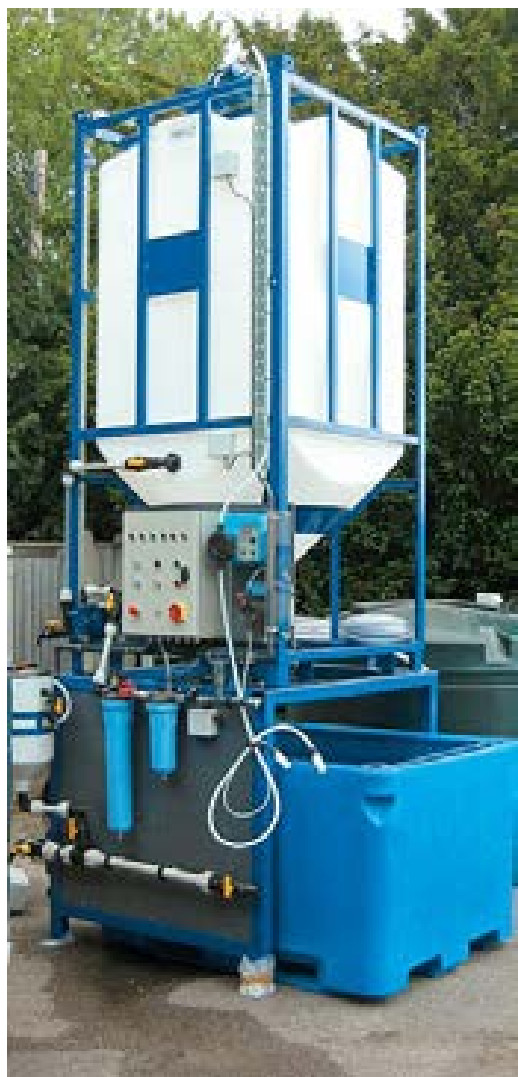
Pour traiter les effluents phytosanitaires issus de traitements post-récolte, le dispositif SENTINEL conçu par WMEC (R-U).
