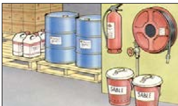
Les produits ne sont pas déposés à même le sol. Le matériel de sécurité est en place.
