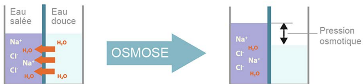
Figure 15 – Représentation schématique du phénomène d'osmose et de la pression osmotique.
