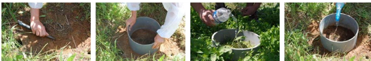
Figure 7 - Enfoncer un cylindre après avoir dégagé la surface. Verser une quantité d'eau et chronométrer le temps d'infiltration dans le sol (Source : Lhote, Rencontre technique Ctifl / Itab).
