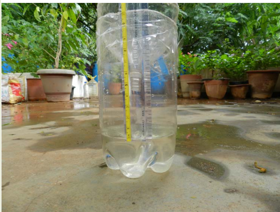
Pluviomètre élémentaire fabriqué à partir d'une bouteille en plastique Source : rainwaterharvesting.wordpress.com/2013/06/08/how-to-make-a-cheap-rain-gauge
