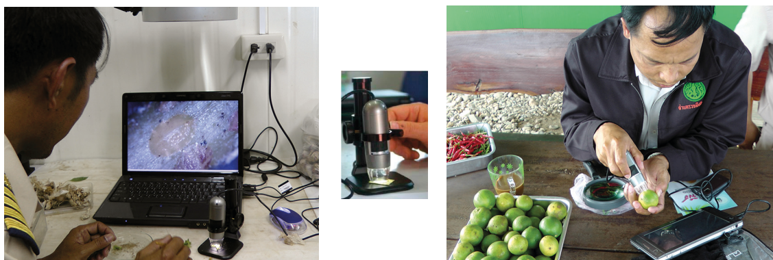
Figure 29 : Gauche : Un microscope USB capture des images sur un PC à un point d'inspection frontalier qui peuvent être partagées avec des spécialistes distants via des outils de collaboration Web tels que Skype. Centre : Un microscope USB à grossissement x 20 - x 200. Droite : Un agent de l'inspection frontalière examine les organismes nuisibles et capture des images à l'aide d'un microscope USB.
