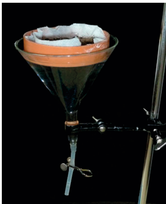
Figure 16: Entonnoir de Baermann modifié pour l'extraction des nématodes du matériel végétal ou du sol
