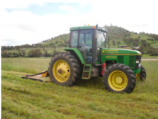
Débroussailleuse montée sur un tracteur pour la lutte contre les mauvaises herbes
