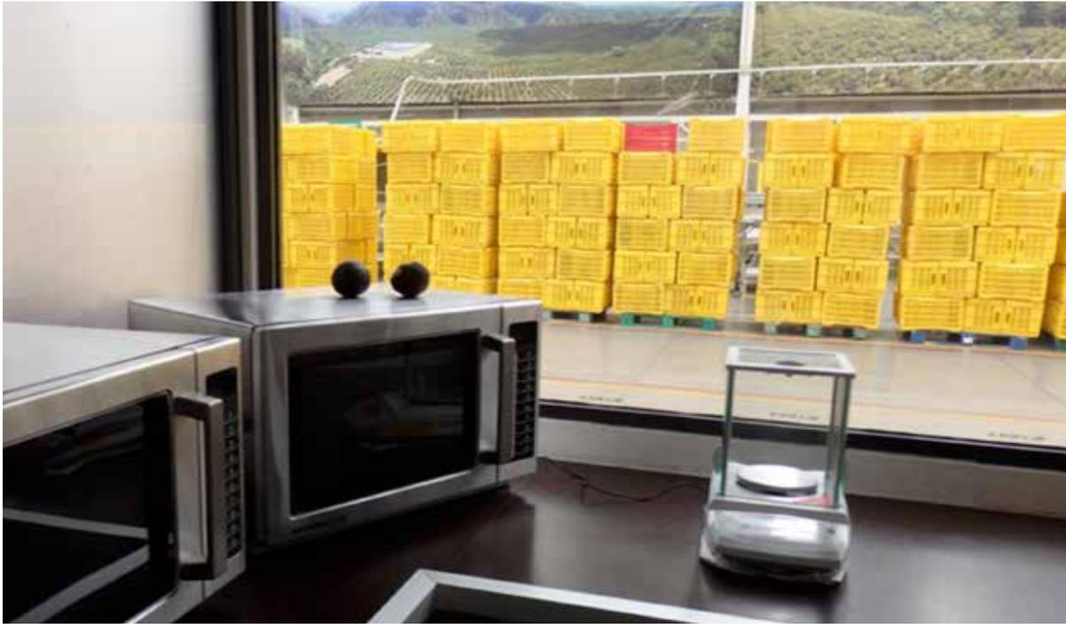
Figure 102 — Matériel simple (micro-ondes et balance numérique) utilisé pour déterminer le degré de maturation des fruits par la méthode de la teneur en matière sèche
