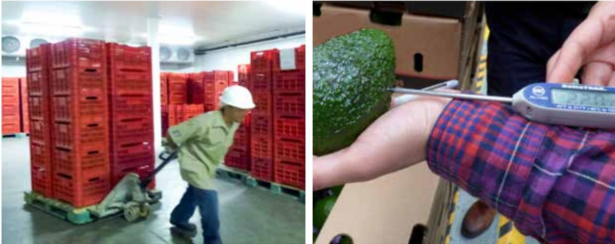
Figure 113 — Refroidissement à l'air pulsé des avocats dans une chambre froide (à gauche) et détermination de la température à l'aide d'une thermosonde (à droite)
