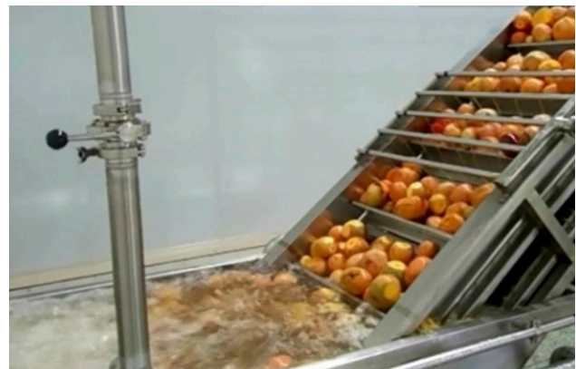
Figure 13. Élévateur hissant les mangues jusqu'au convoyeur de tri
