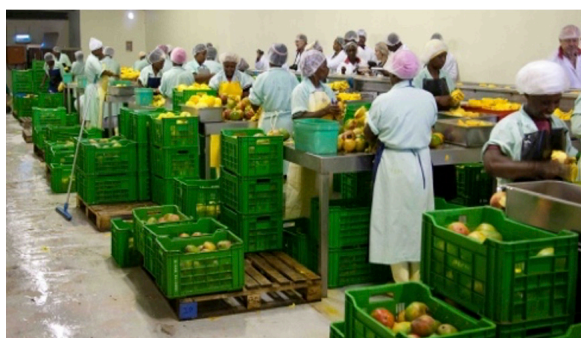
Figure 12. Épluchage et découpe de la mangue dans une usine LVA Source : auteurs (visite d'usine).
