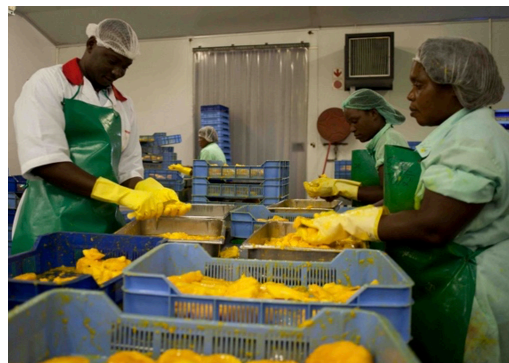
Figure 13. Découpe en cubes et criblage des cubes Source : auteurs (visites d'usines).
