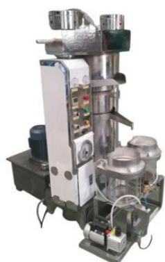
Une presse hydraulique est une machine qui génère une force de compression. La pression dans le système fermé est constante. Une partie du système est un piston agissant comme une pompe, avec une force mécanique modeste agissant sur une petite surface de section transversale ; l'autre partie est un piston avec une plus grande surface qui génère une force mécanique correspondante importante.
