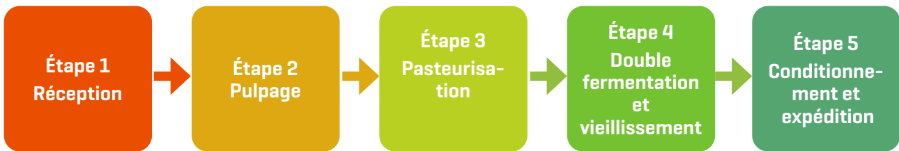
Figure 2. Processus de production du vinaigre de mangue
