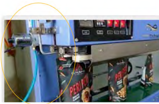
Figure 19. Machine à former, remplir et sceller les sacs avec unité d'injection d'azote intégrée
