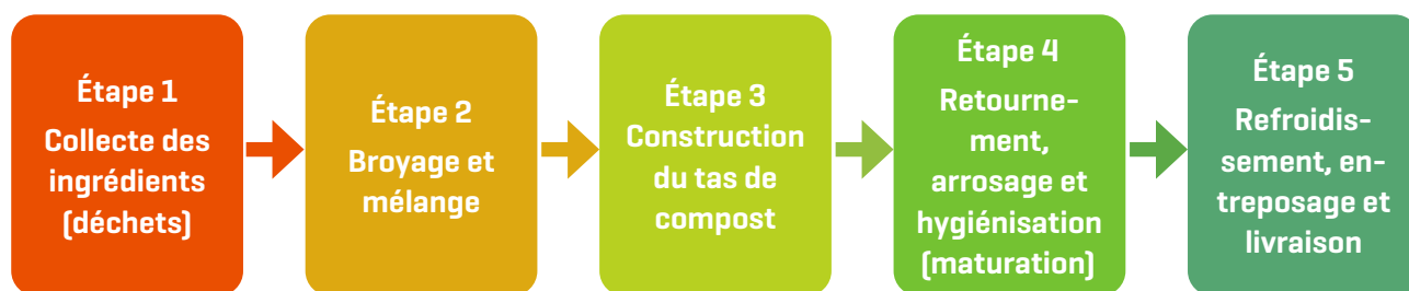
Figure 3. Processus de production de compost de déchets de mangue – technique aérobie
