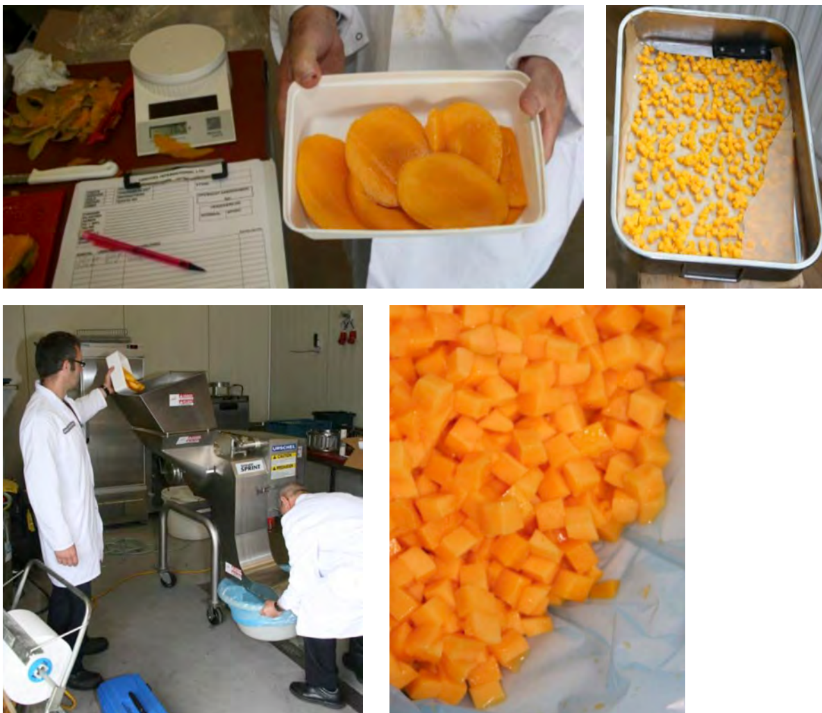
Figure 17. Production d'échantillons IQF : découpe et pesage des joues (en haut à gauche), découpe en cubes à la machine (en bas à gauche), récupération des cubes fraîchement découpés (en bas à droite) et surgélation des cubes (en haut à droite)
