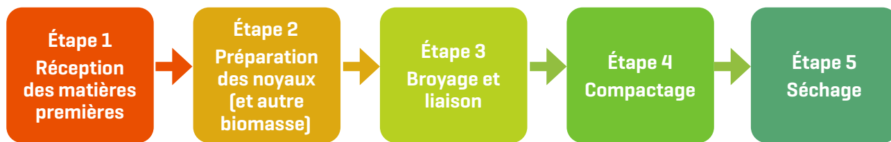
Figure 2. Étapes types de la production de briquettes de biomasse
