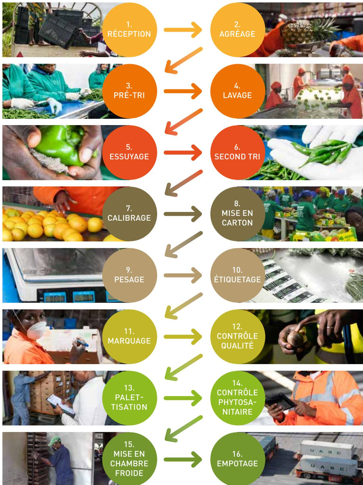
Figure 1 — Exemple de « flow-chart » du processus de conditionnement dans une entreprise qui produit et met sur le marché des fruits et légumes frais (ici des mangues).
