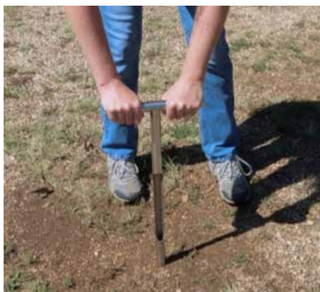
Figure 18 : Exemple d'échantillonneur de sol en acier inoxydable pour évaluer la qualité du sol des champs cibles (Penn Ltd)
